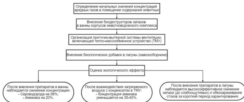
Рисунок 12 – Алгоритм комплексной системы создания параметров микроклимата в животноводческих помещениях с элементами охраны воздушного бассейна
