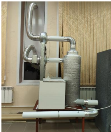
Рисунок 7 – Фото экспериментального стенда для исследования работы теплообменного устройства
